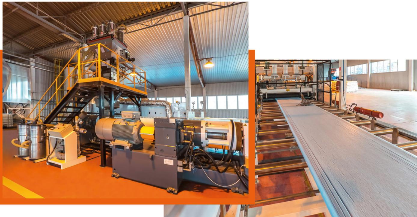
Поначалу технология производства экструдированного пенополистирола представляла собой его вспенивание посредством фреонов. После многочисленных протестов экологов и проведения исследований, установивших, что фреоны входят в список веществ, применение которых участвует в разрушении озонового слоя Земли, в производстве пенополистирола стали использовать углекислый газ CO<sub>2</sub> как вспенивающий агент.
