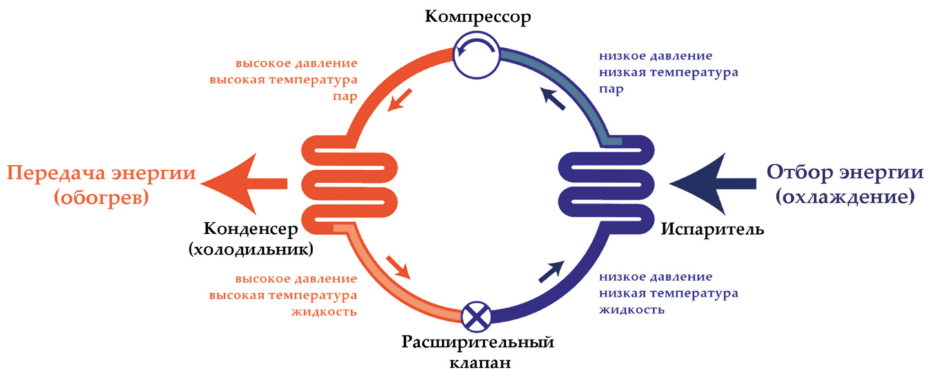
Принцип действия теплового насоса
