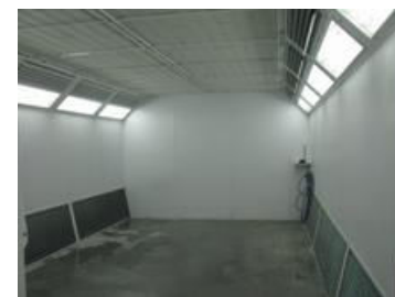
Покрасочная камера с увеличенным воздушным потоком для работы с водорастворимыми красками
