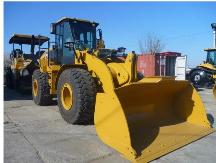
Фронтальный погрузчик Cat® 950 GC предназначен для работы различными разрыхленными материалами: погрузки материалов с перевозкой, погрузки бункеров заводов, дробилок, самосвалов, планирования строительных площадок, работы в сельском хозяйстве..
